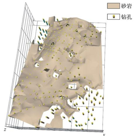
图 12 砂岩三维模型
