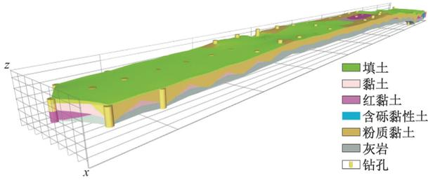
图 7 研究区 2 钻孔及地层三维模型
