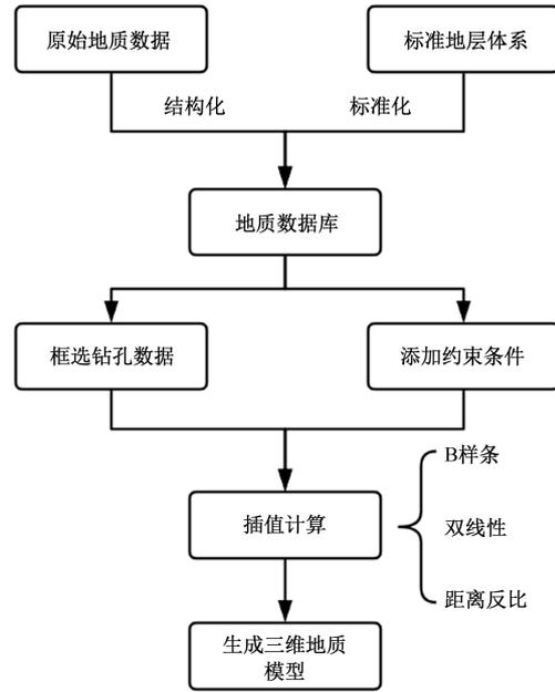
图2 基于钻孔全自动建模流程
