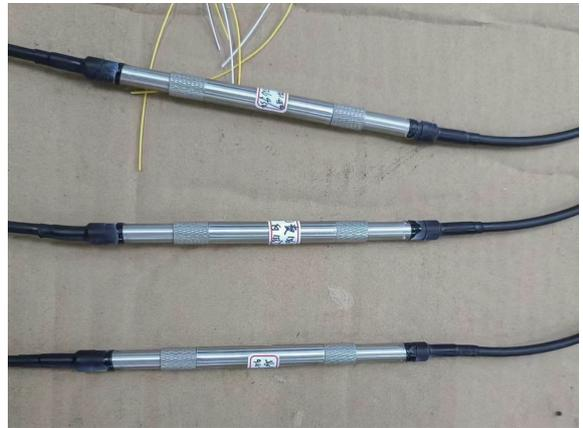
图2 光纤光栅应变传感器封装实物图
