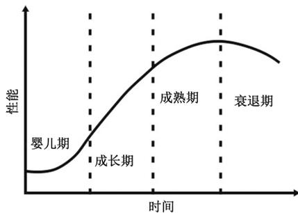
图1 技术系统进化的S曲线
