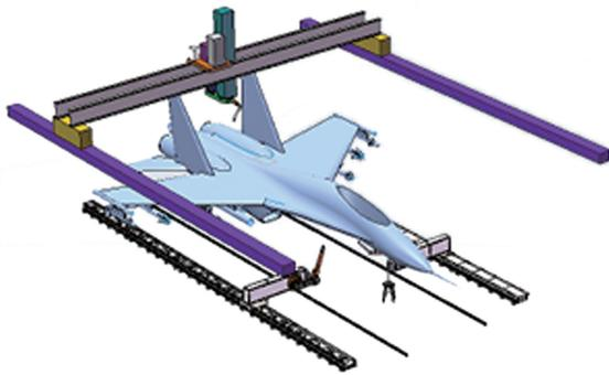
图4 喷涂系统布置图<sup>[15]</sup>
