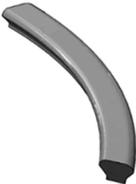
图6 飞机发动机叶片燕尾基座结构图<sup>[17]</sup>
