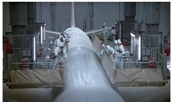
图 3 波音公司整机喷涂系统<sup>[14]</sup>
