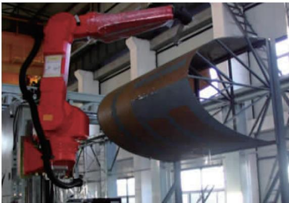
图 1 模拟工件实际喷涂试验<sup>[12]</sup>
