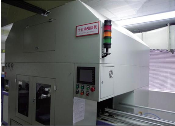
图 8 全自动喷涂机实物图<sup>[19]</sup>
