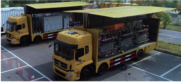
图9 空负载试验平台1号车和2号车实物
