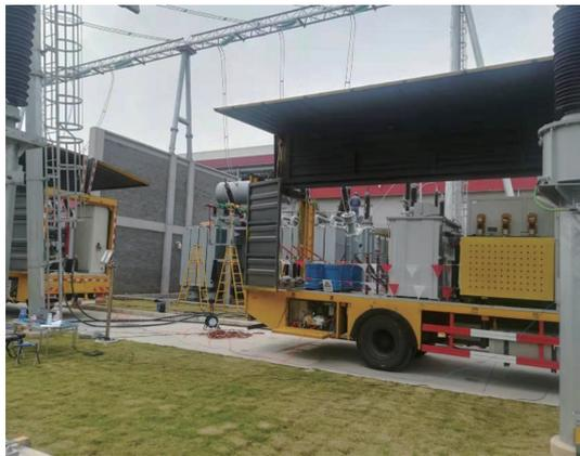
图11 空负载试验平台1号车和2号车试验现场
