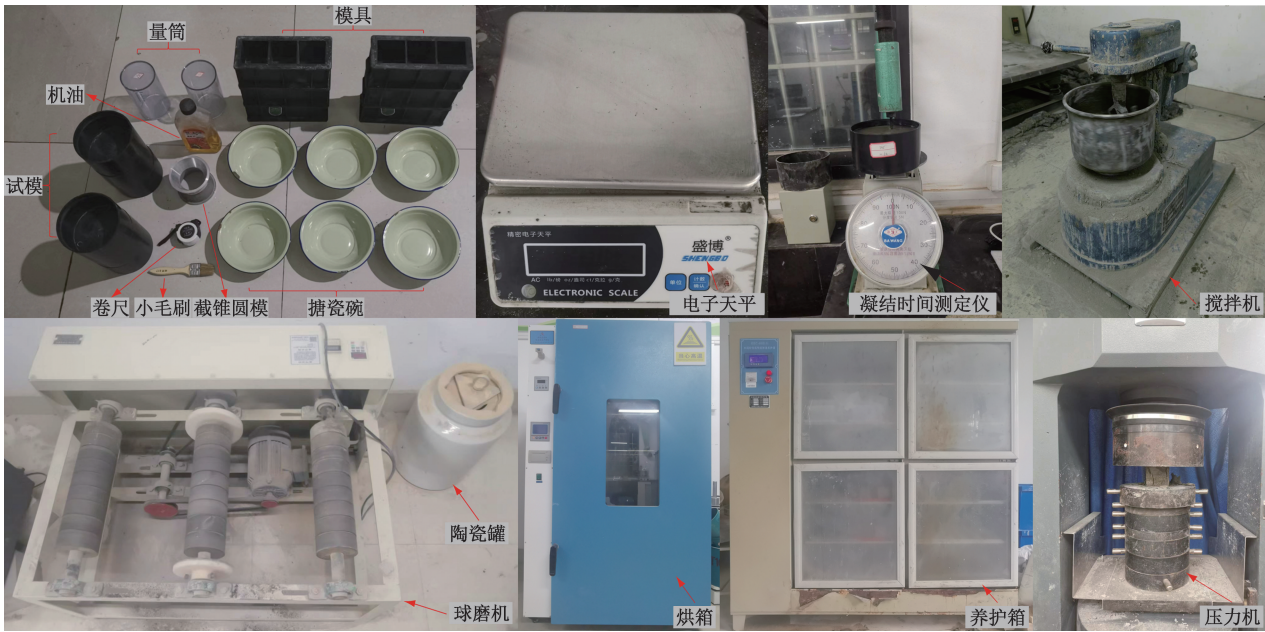
图 4 同步注浆材料试验设备
