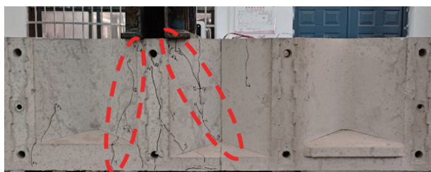
图 17 受剪加载试验试件破坏形态
