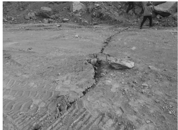
(a) 古滑坡坡脚处开裂
