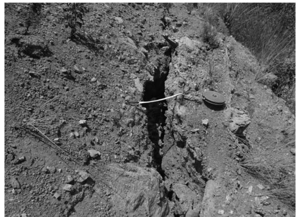
(b) 古滑坡体坡面裂缝
