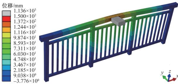
图9 FRP防护栏杆冲击过程水平位移云图
