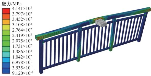
图8 FRP防护栏杆冲击过程应力云图
