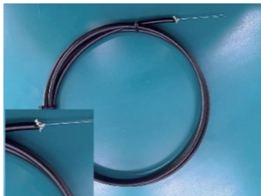
(b) 铜网内加热温度感测光缆
