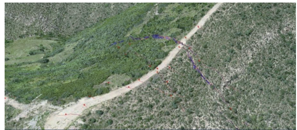
图 14 30507 工作面切眼处的裂隙分布
