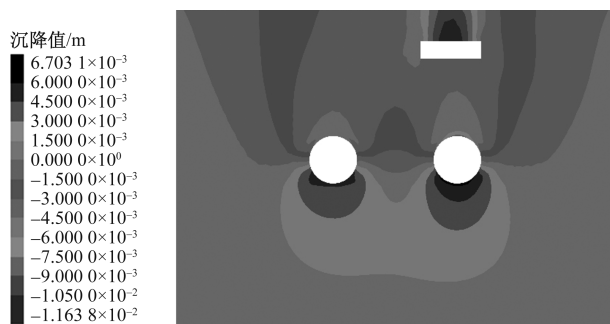
图4 隧道掘进剖面数值沉降(土体加固)
