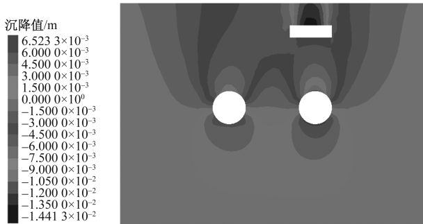
图6 隧道掘进剖面数值沉降(未土体加固)
