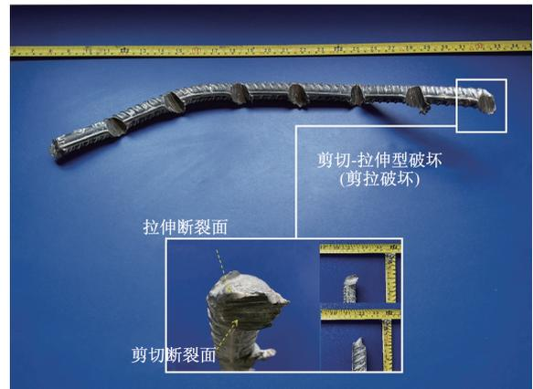
图11 剪拉破坏钢筋
