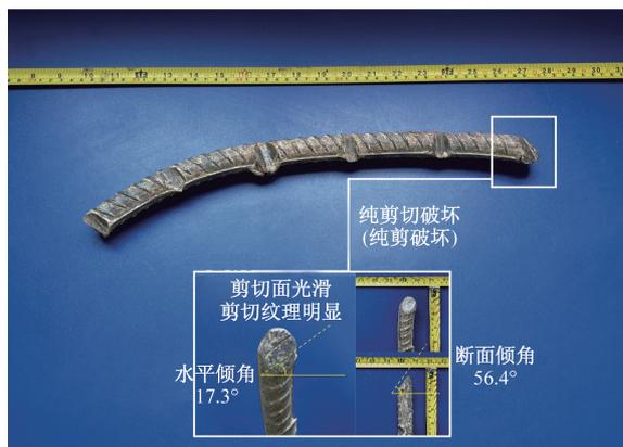
图 13 纯剪破坏钢筋
