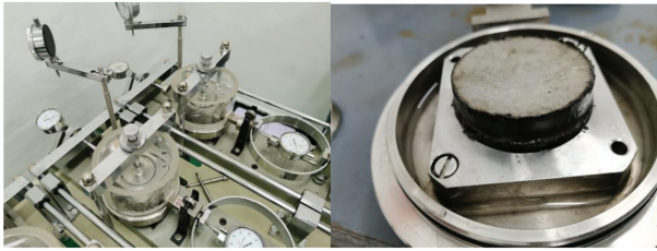
图 1 ZLB-1 型三联蠕变直剪蠕变仪及试样
