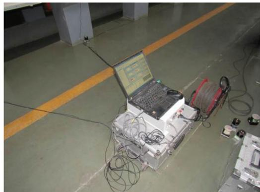
图3 柱根部振动测点
