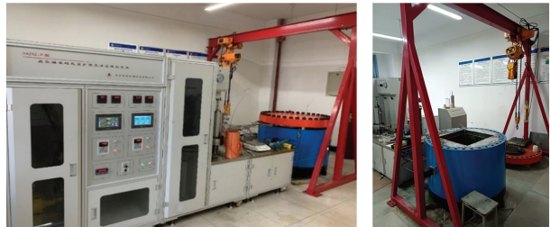
图 4 真三轴裂缝起裂扩展及渗流模拟系统实物图
