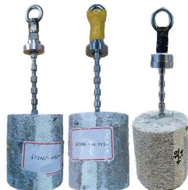
图 2 试样制备及井筒固结
