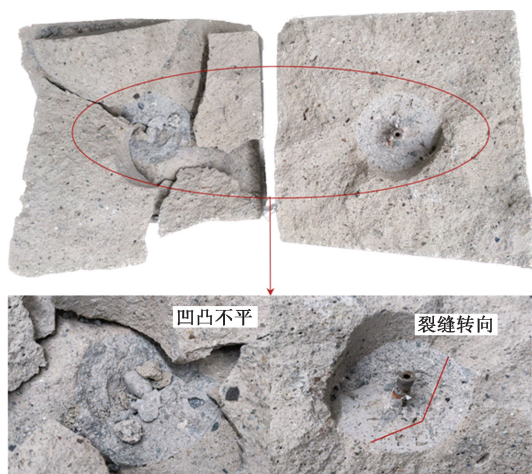
图 11 超临界二氧化碳压后岩样剖面
