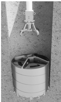
图 9 机械手孔内下放模拟图
