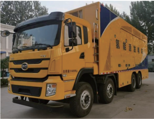
图 6 氢燃料电池发电车照片
