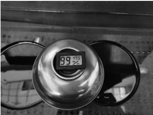
图 10 沥青混合料经受水气侵蚀
