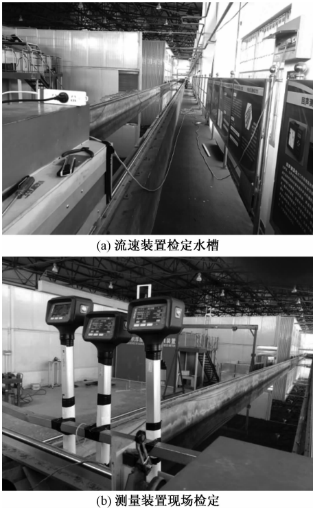
图 8 流速装置检定水槽及现场检定
