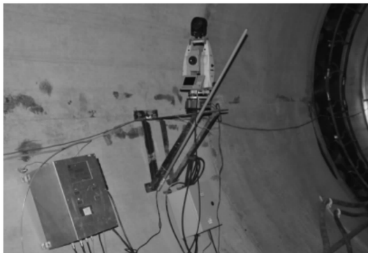
图2 管壁移动测站
