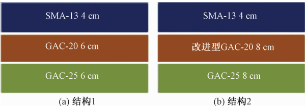
图 4 界面约束复合车辙板试件
