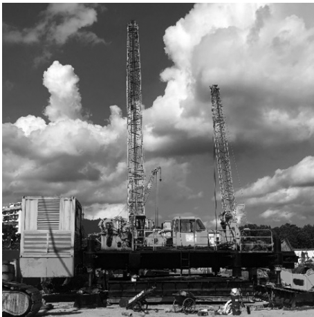
图 11 SHX 型多功能钻机
