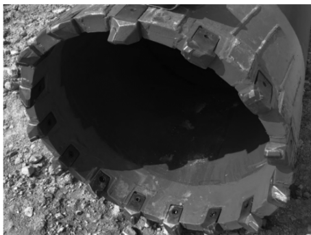
图 10 护筒底管靴及合金切削刀头
