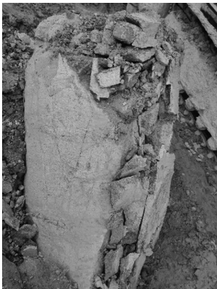
图 16 取出破碎中风化岩芯
