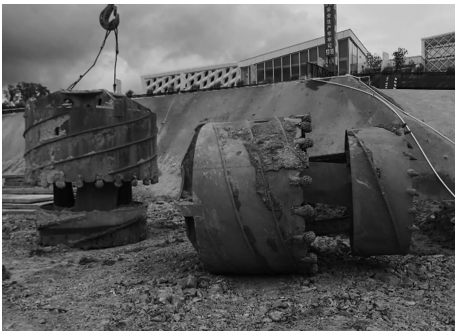
图 5 第二级、第三级下扶正钻头实物
