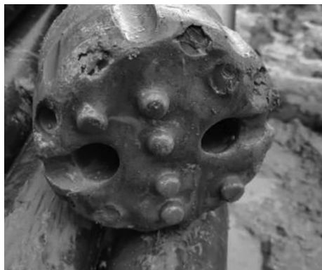
图5 潜孔锤锤齿崩落
