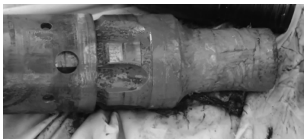
图6 潜孔锤岩粉堵塞
