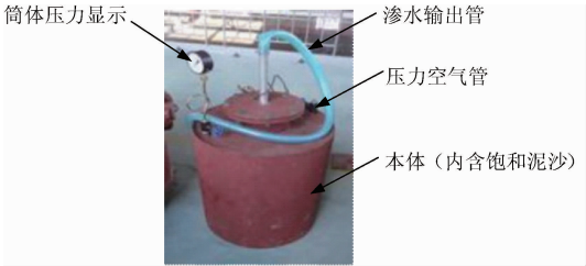
图 7 渗水率测试实验装置
