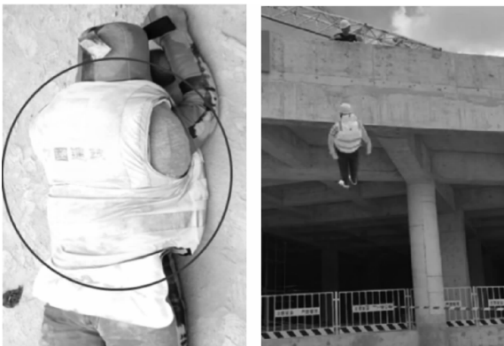
图 10 施工现场假人高坠测试试验
