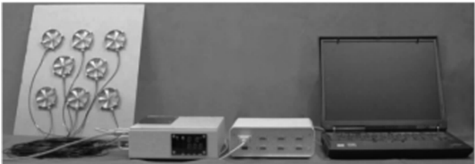
图 5 RF-1000 散热器风速测量系统
