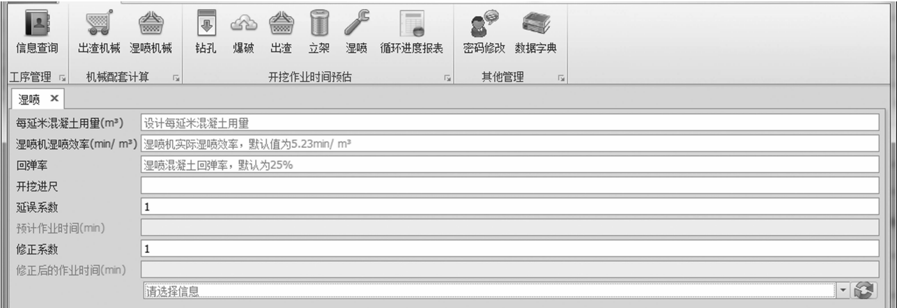
图 10 湿喷工序作业时间预估界面
