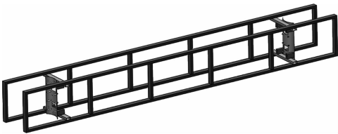
图 1 抱柱式站台显示屏固定结构模型
