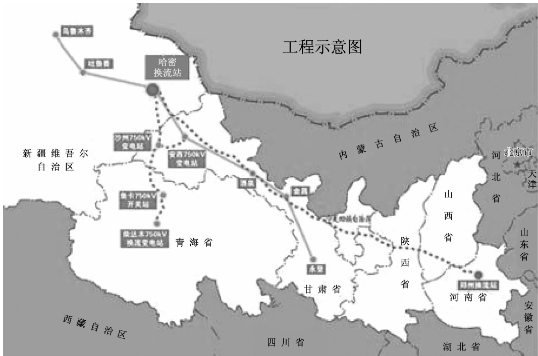
图 7 哈密—郑州±800 千伏特高压直流风光火打捆外送工程
