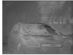
图10 汽车热红外图像
