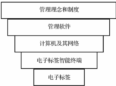
图3 基于电子标签的物流信息自动采集和处理系统结构
