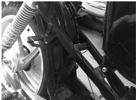
\phi 20 \times 2 方形管横梁
