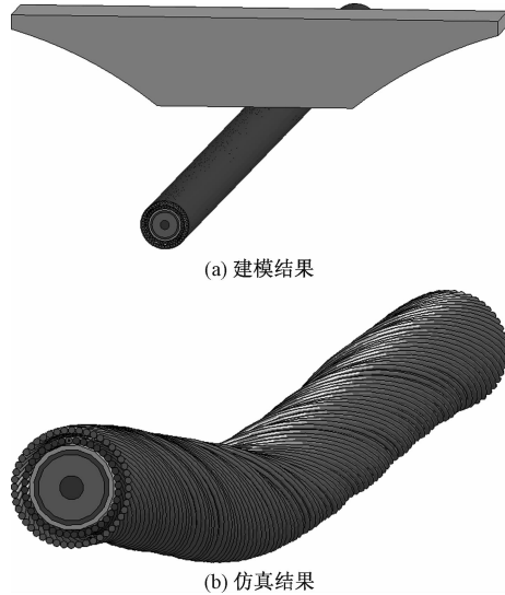
图 10 锚砸状态下的海缆的建模和仿真结果
