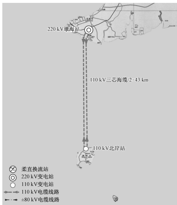
图1 涠洲岛联网工程中拟定的海缆铺设示意图
