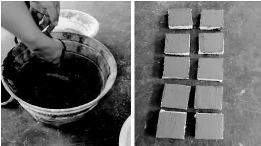
图 1 粘接砂浆制备及试样制作
