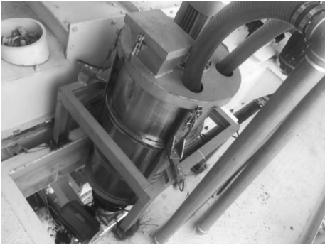
图 3 环氧树脂混合搅拌装置
